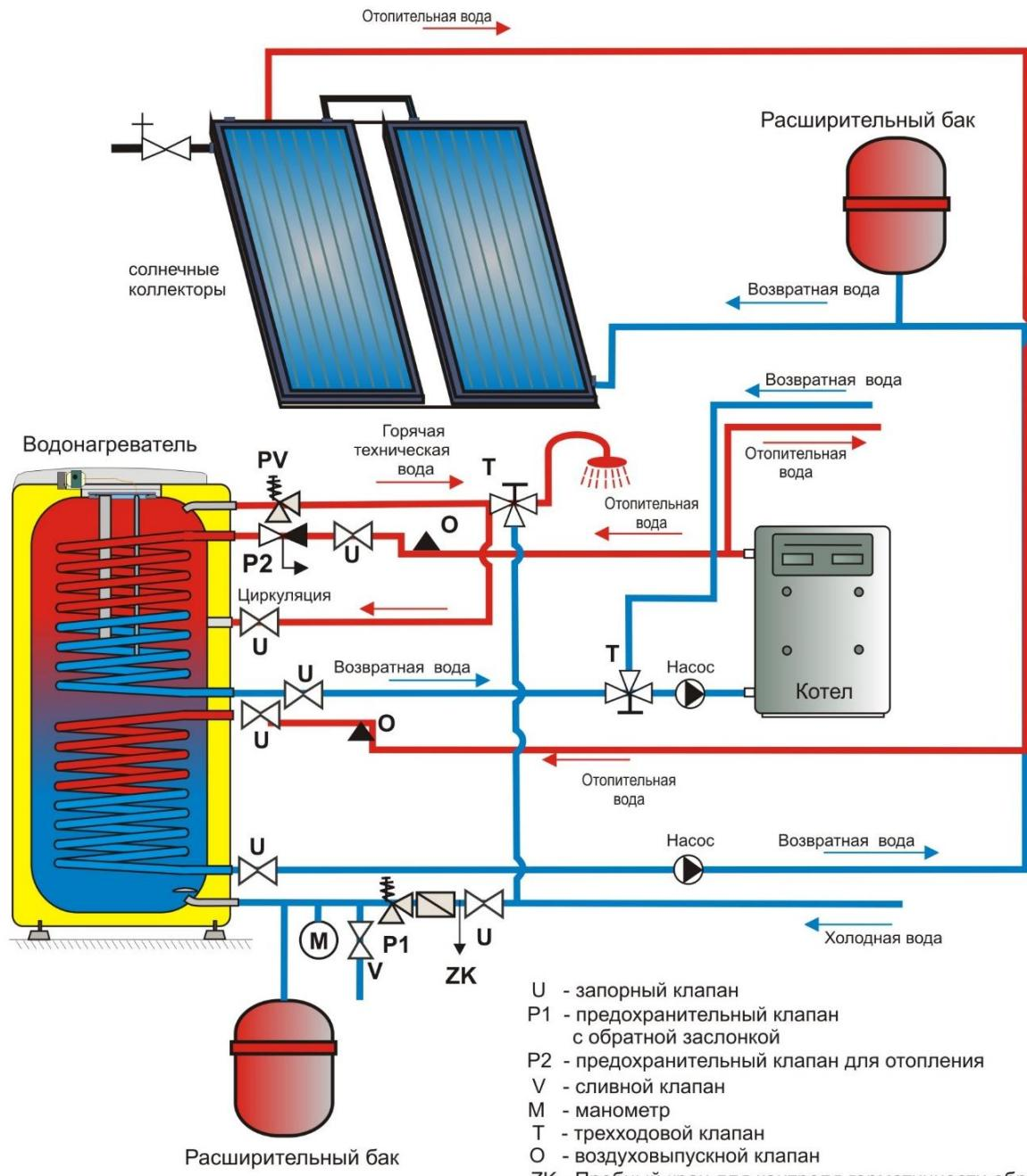
\* Использование расширительного бака не является условием правильного подключения, это лишь возможный вариант решения
