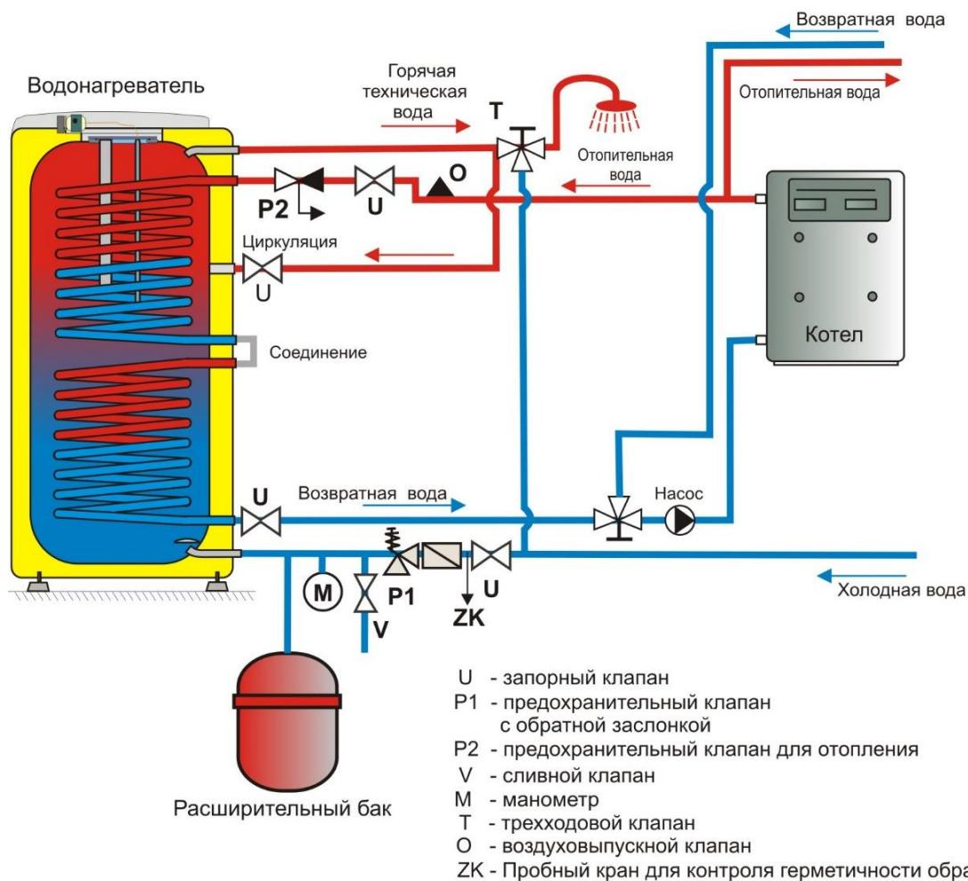
\* Использование расширительного бака не является условием правильного подключения, это лишь возможный вариант решения
