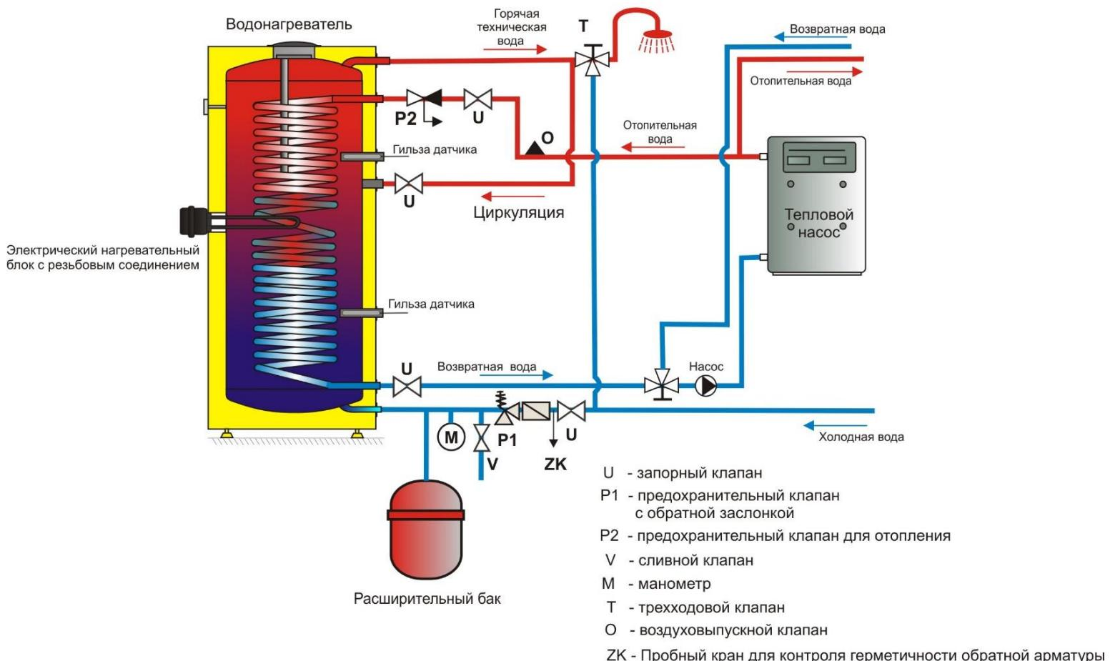
\* Использование расширительного бака не является условием правильного подключения, это лишь возможный вариант решения
