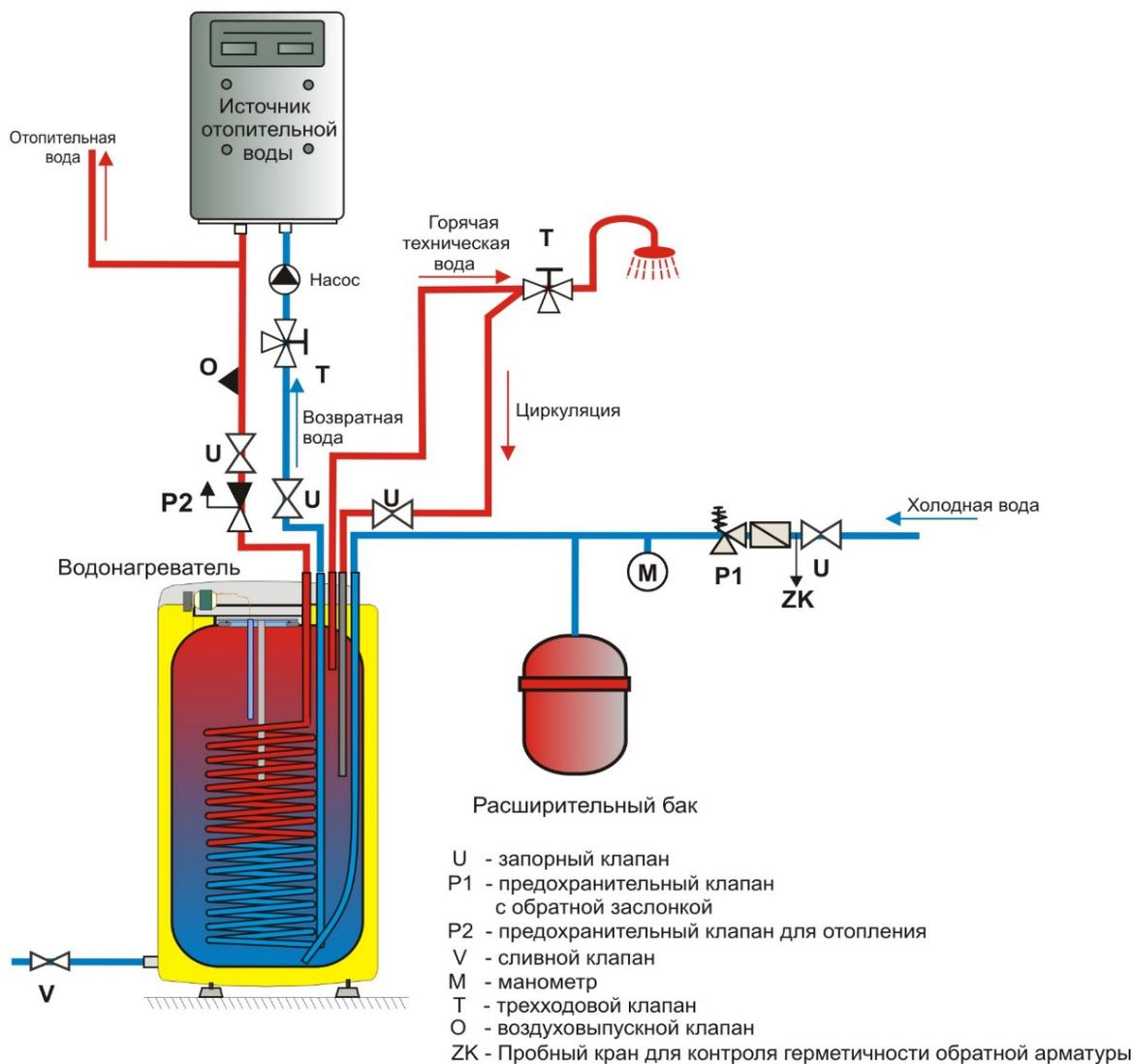
\* Использование расширительного бака не является условием правильного подключения, это лишь возможный вариант решения
